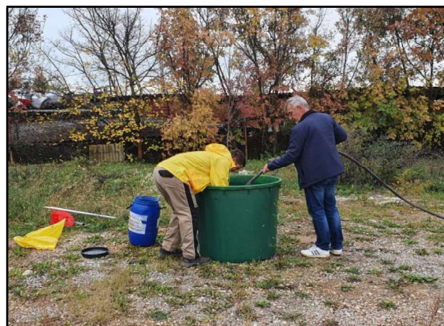
Slika 3.1.10: Ispiranje trasera po izvršenom upuštanju u podzemlje
