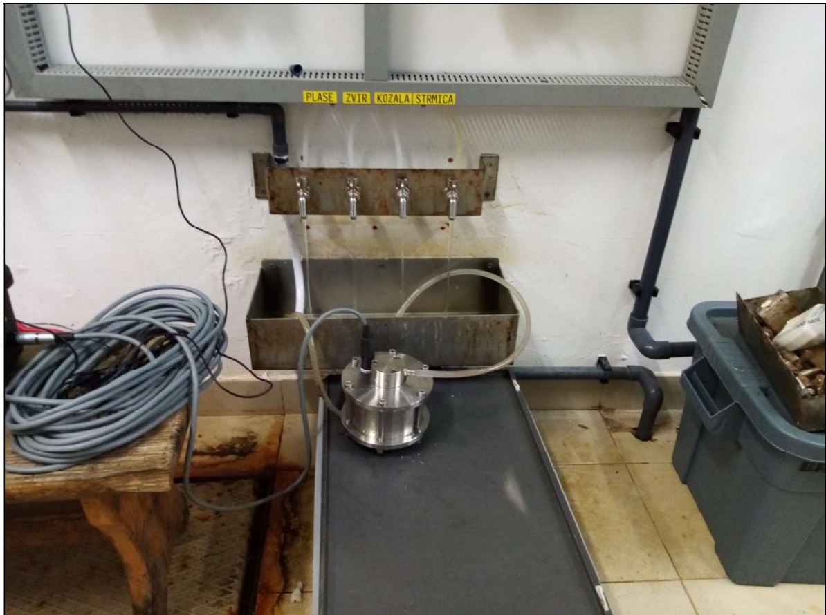
Slika 3.5: In situ očitavanje koncentracije trasera terenskim fluorometrom (Zvir)
