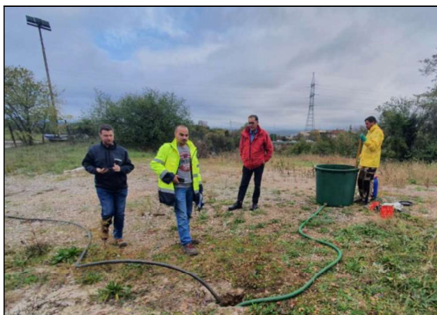
Slika 3.1.9: Priprema i upuštanje trasera Na-fluoresceina u bušotinu B-6
